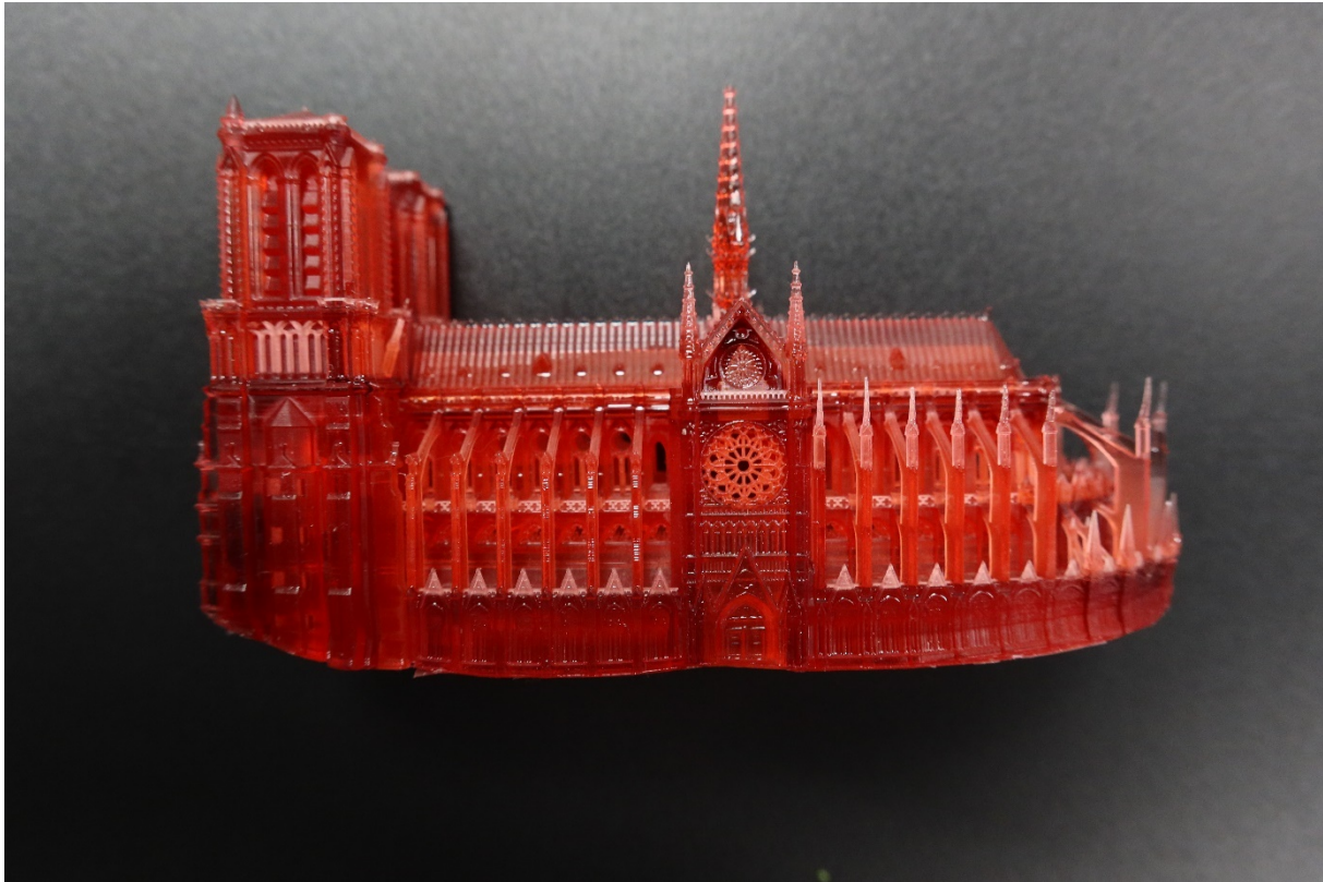
Abbildung 11 Verformung durch falsche Positionierung und fehlendes Stützmaterial an den Rändern
