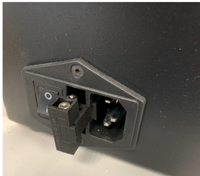
Abbildung 2 Schmelzsicherung am Netzteil (ausgebaut)
