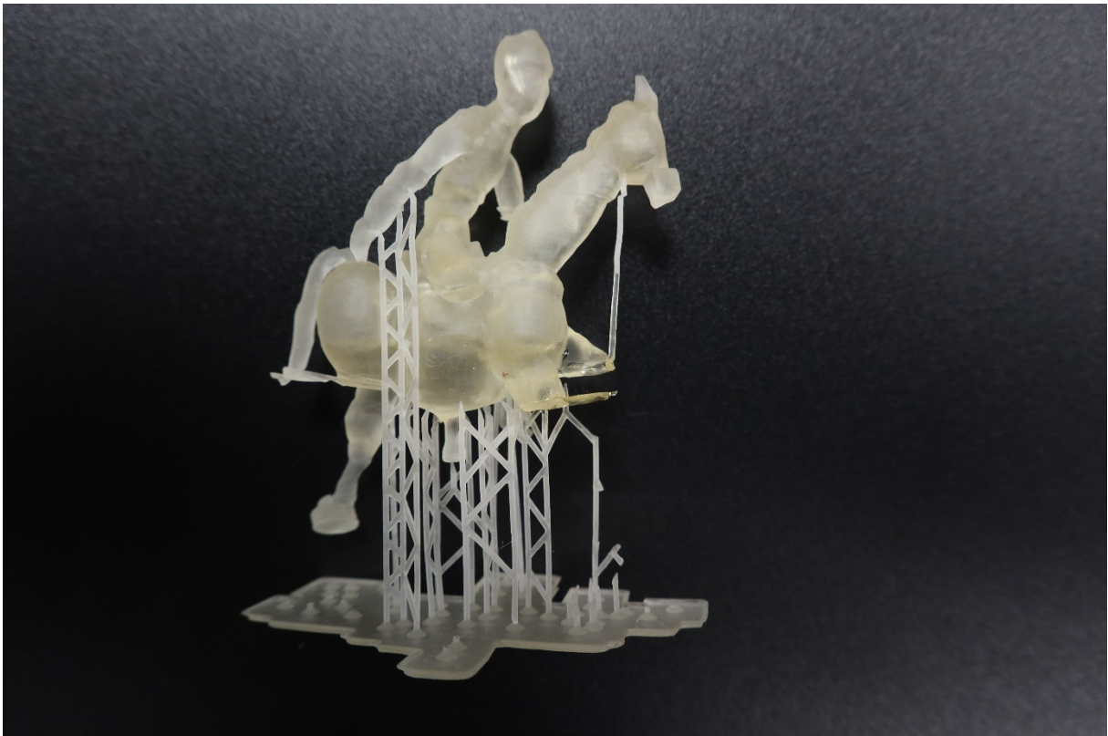
Abbildung 10 Unzureichendes Stützmaterial
