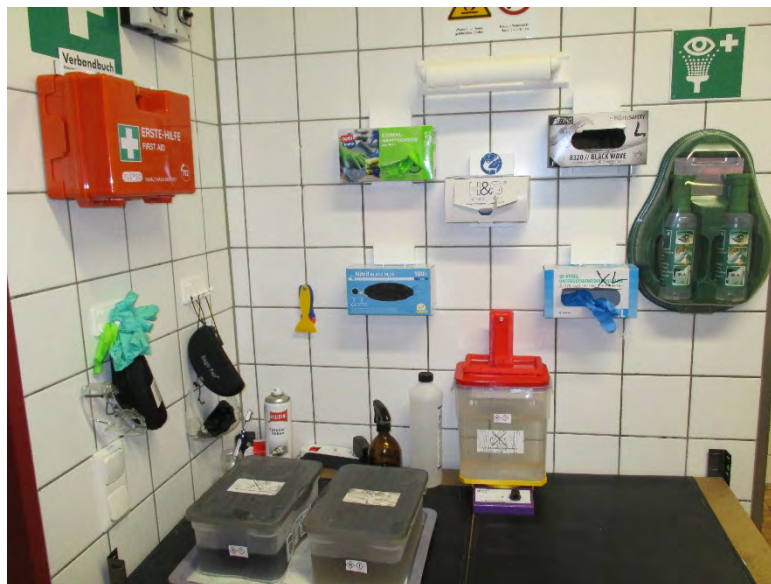
Abbildung 23 SLA-Reinigungsstation mit drei Reinigungsbädern
