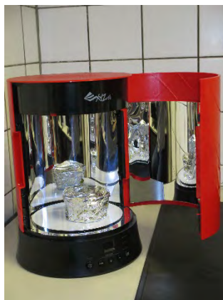
Abbildung 24 UV-Härtekammer der Firma XYZprinting
