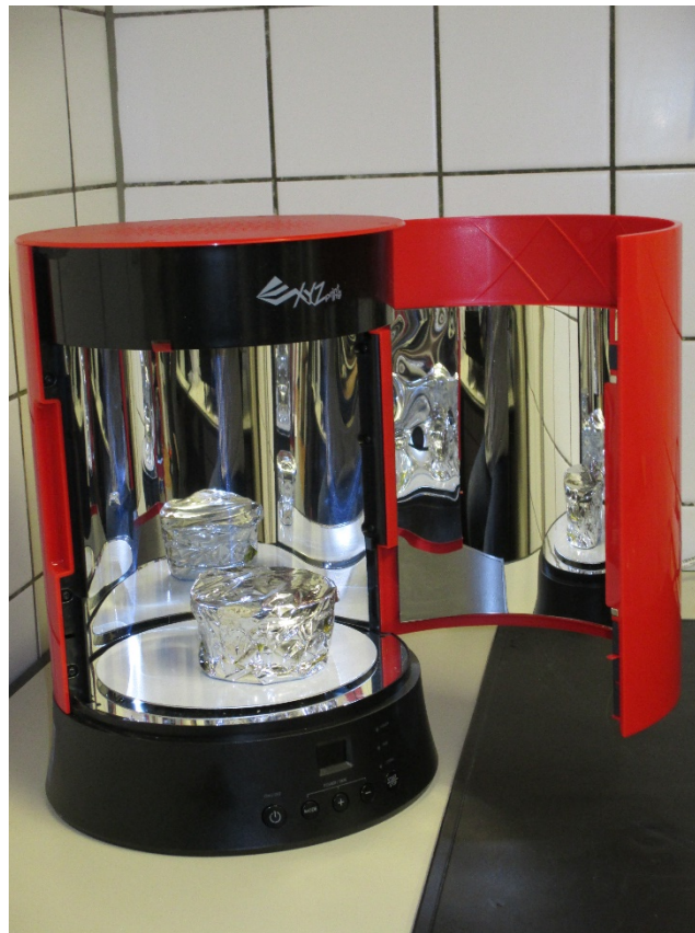
Abbildung 9 Härtekammer (Beispiel XYZ Printing) mit Spiegeleinheit
