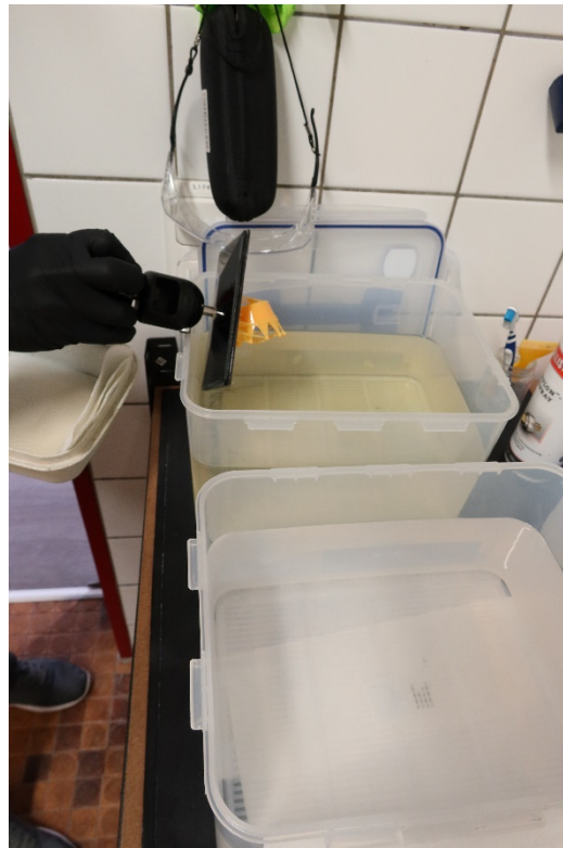
Abbildung 4 Abstellen der Bauplatte in das Reinigungsbad
