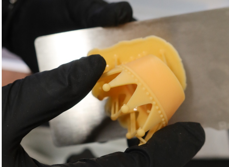
Abbildung 7 Ablösen des Bauteils von einer flexiblen Folie
